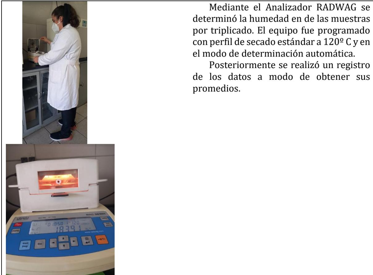
Mediante el Analizador RADWAG se determinó la humedad en de las muestras por triplicado. El equipo fue programado con perfil de secado estándar a 120° C y en el modo de determinación automática.
