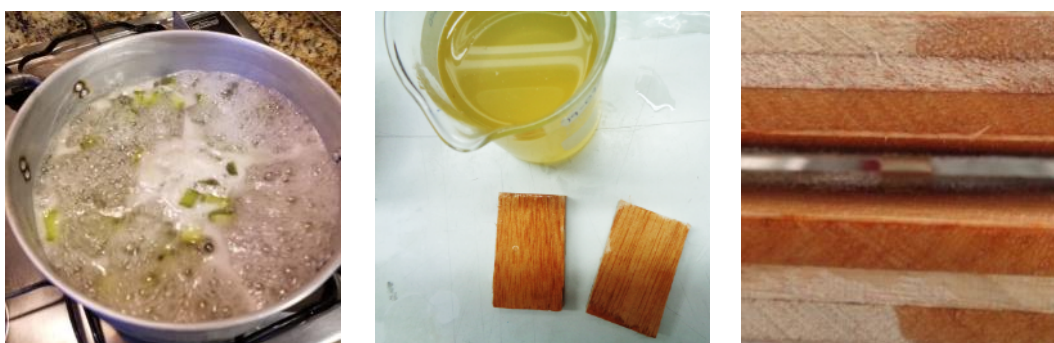
Figura 7. Mucilago cocido a 80°C, y su efectividad como adhesivo.
