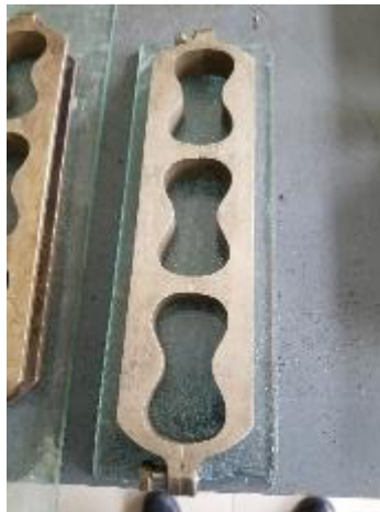
Figura 12. Molde para prueba de tracción
