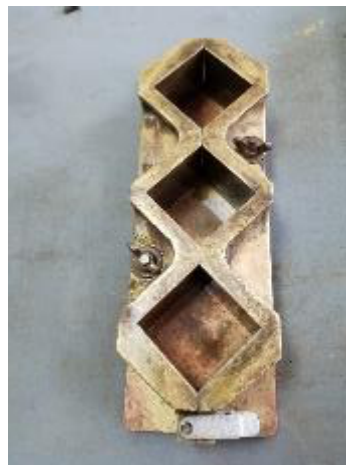
Figura 10. Molde para la prueba de compresión
