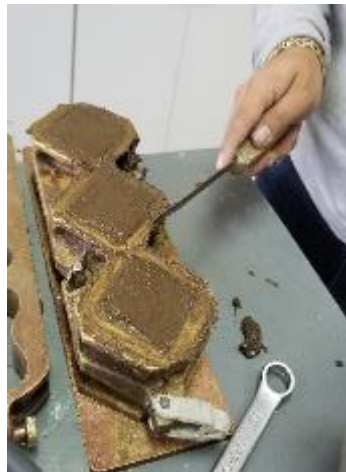
Figura 15. Probetas de ensayo de compresión
