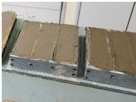
Figura 21. Probetas de ensayo de flexión
