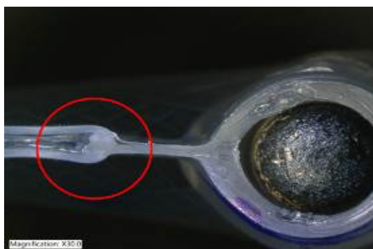
Figura 16. Soldadura rechazada por inspección visual
