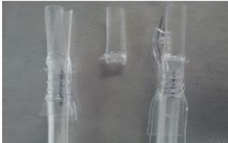
Figura 21. Soldadura aceptable, prueba de desprendimiento de tubo versus la capa de EVA o EVA/EVOH.
